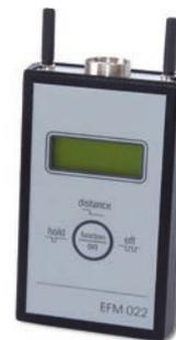
Appareil de mesure EFM.
